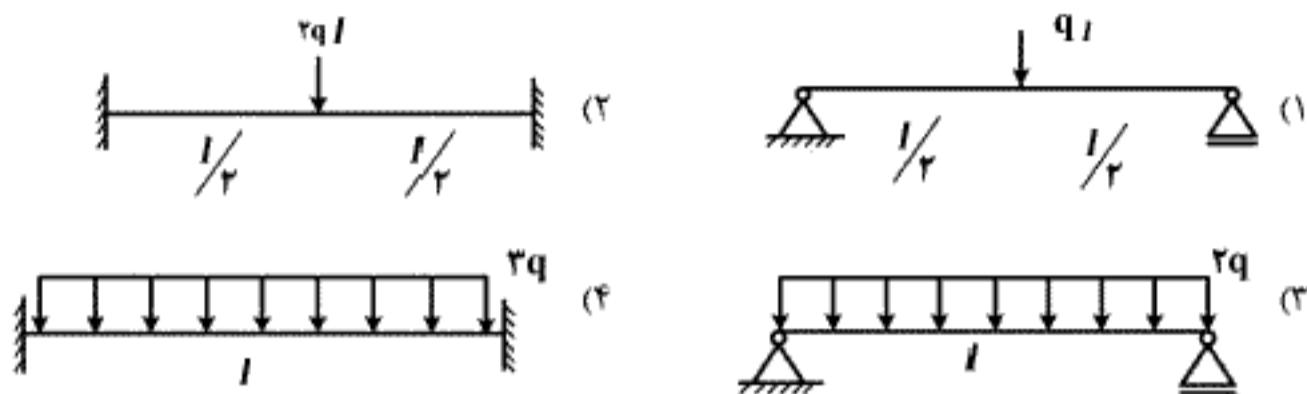
۱۱۰ - ظرفیت خمشی پلاستیک تیر مركب شکل زیر چند تن - متر است؟
