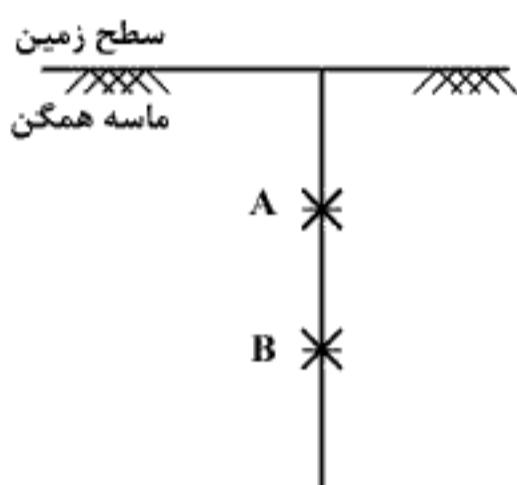
$$\text{عدد نفوذ استاندارد اندازه‌گیری شده در نقاط B و A} \quad N_B, N_A$$
