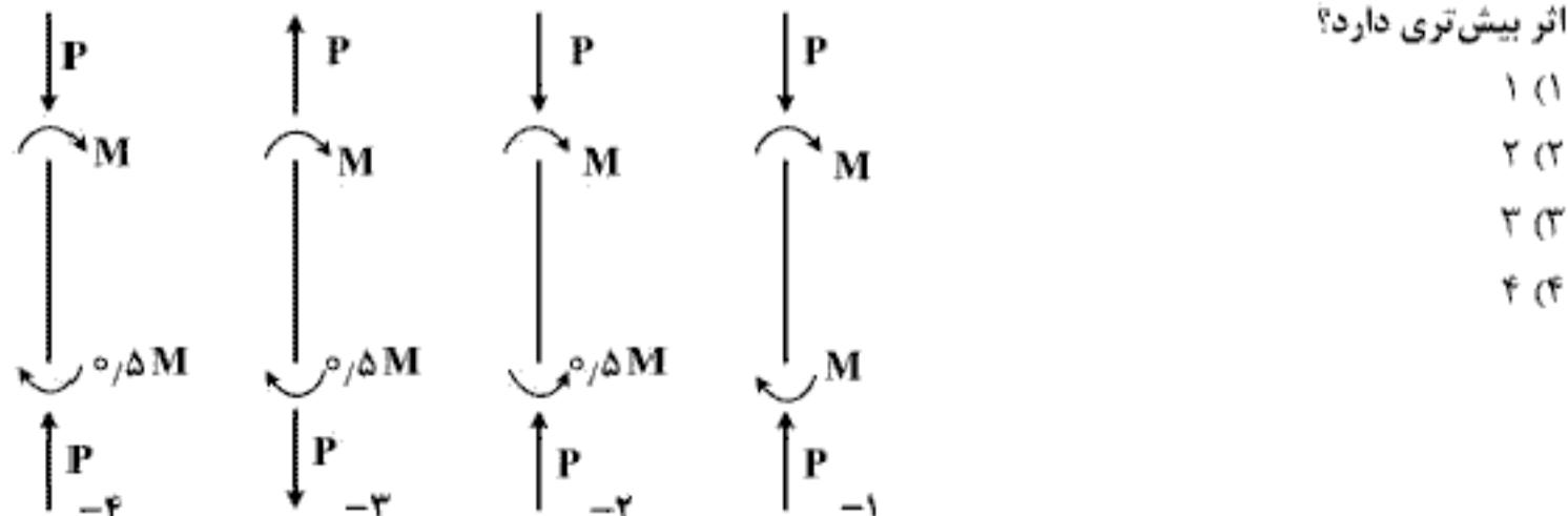
۱۰۹ - چنانچه تمامی تیرهای زیر از مقاطع یکسان تشکیل شده باشند و برای طراحی آنها کمانش پیچشی جانبی بحرانی ترین حالت باشد، کدام تیر ظرفیت خمشی کمتری دارد؟
