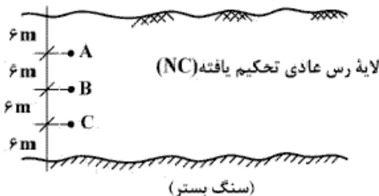
$$C_{U,A} < C_{U,B} < C_{U,C} \quad (1)$$
