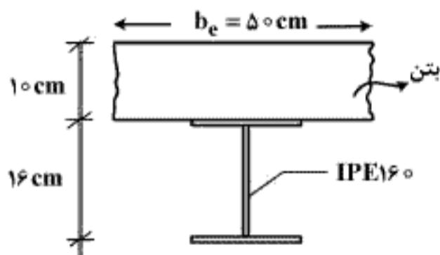
۱۱۱ - در نیمروخ سپری شکل زیر، ضریب شکل نیمروخ  $\left(\frac{Z}{S}\right)$  به کدامیک از گزینه‌های زیر نزدیک‌تر است؟
