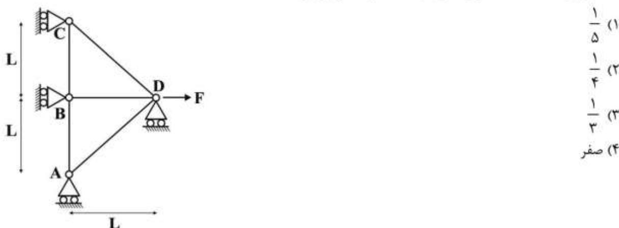
۶۲- در خرپای مربع شکل داده شده، عضو  $BD$  به اندازه  $2L$  کوتاه‌تر بریده شده است. اگر صلبیت محوری اعضاي قطری  $EA\sqrt{2}$  و سایر اعضا  $EA$  و  $EA = 10^3 \text{ ton}$  باشد، پس از ساختن خرپا، چه نیرویی در عضو  $BD$  بر حسب تن ایجاد می‌شود؟
