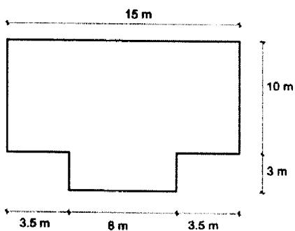
۵۷- در مورد ساختمان اداری آجری یک طبقه با کلاف و با دیوارهای باربر ۳۵ سانتیمتری، چنانچه ارتفاع از روی کلاف زیرین دیوار تا زیر سقف برابر ۵.۵ متر باشد، برای تامین اینمی لرزه‌ای کدامیک از گزینه‌های زیر مناسب‌تر است؟
