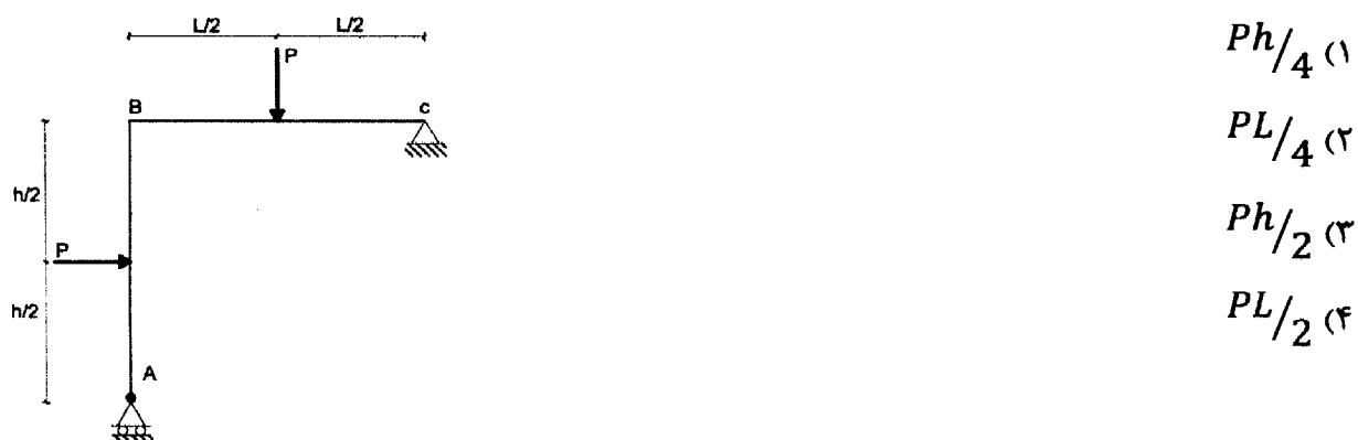
۲۵- در سازه نشان داده شده در شکل زیر، چنانچه تیرها به لحاظ محوری و خمشی صلب فرض شوند، حداکثر لنگر خمشی بوجود آمده در ستون AB به کدامیک از مقادیر زیر نزدیکتر است؟
