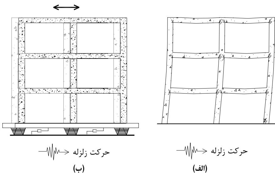
شکل ۱-۱- رفتار سازه (الف) بدون سامانه‌ی جdasاز لرزه‌ای و استفاده از شکل‌پذیری، (ب) به همراه سامانه‌ی جdasاز لرزه‌ای
