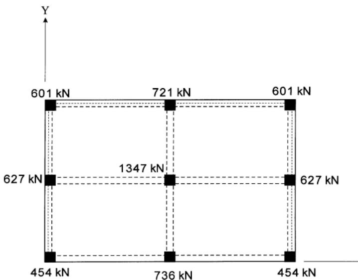
شکل پ-۲-۳- مقدار نیروی قائم ناشی از بار مرده و زنده در پای هر ستون
