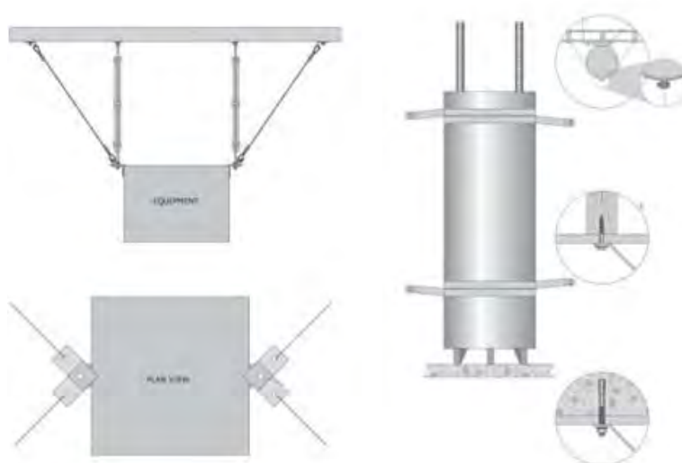
شکل ۱۰-۱۶ - دورگیری و مهار منابع تولید حرارت آب
