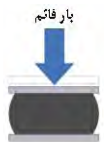
شکل ۶-۵- تغییر شکل قائم جداگر لاستیکی خالص
