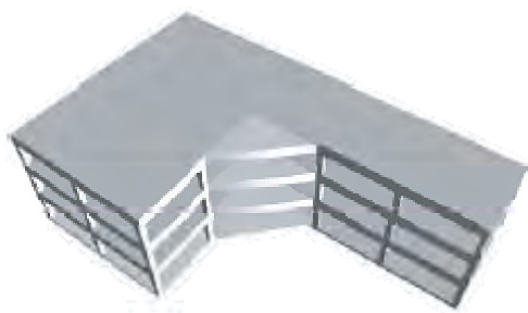
د- حذف کنج های فرورفته با استفاده از پخی ها
