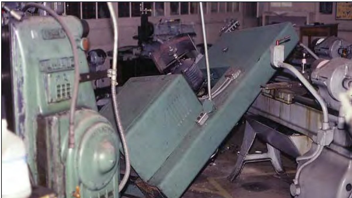
شکل ۱-۱۰- واژگونی تجهیزات سنگین در هنگام زلزله
