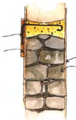
شکل ۹-۱۰ گل میخ‌های برشی برای نصب تسمه لرزه‌ای
