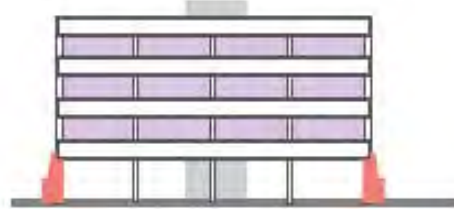
پ- اضافه کردن دیوار حائل
