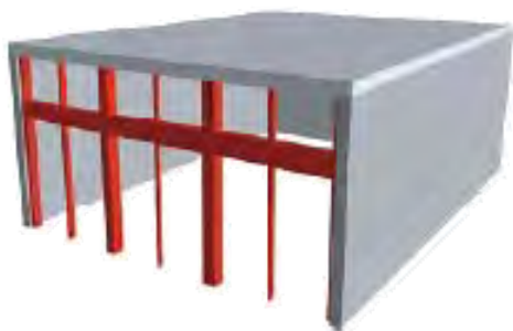
د- اضافه کردن قاب خمشی
