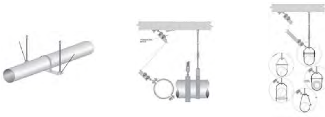
شکل ۱۰-۲۱ - مهارهای جانبی برای لوله‌ها
