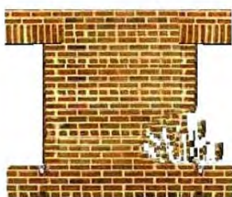
(د) مود شکست بر اثر فشار در پنجه
