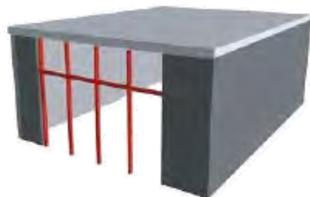
الف- اضافه کردن دیوارهای سازه‌ای
