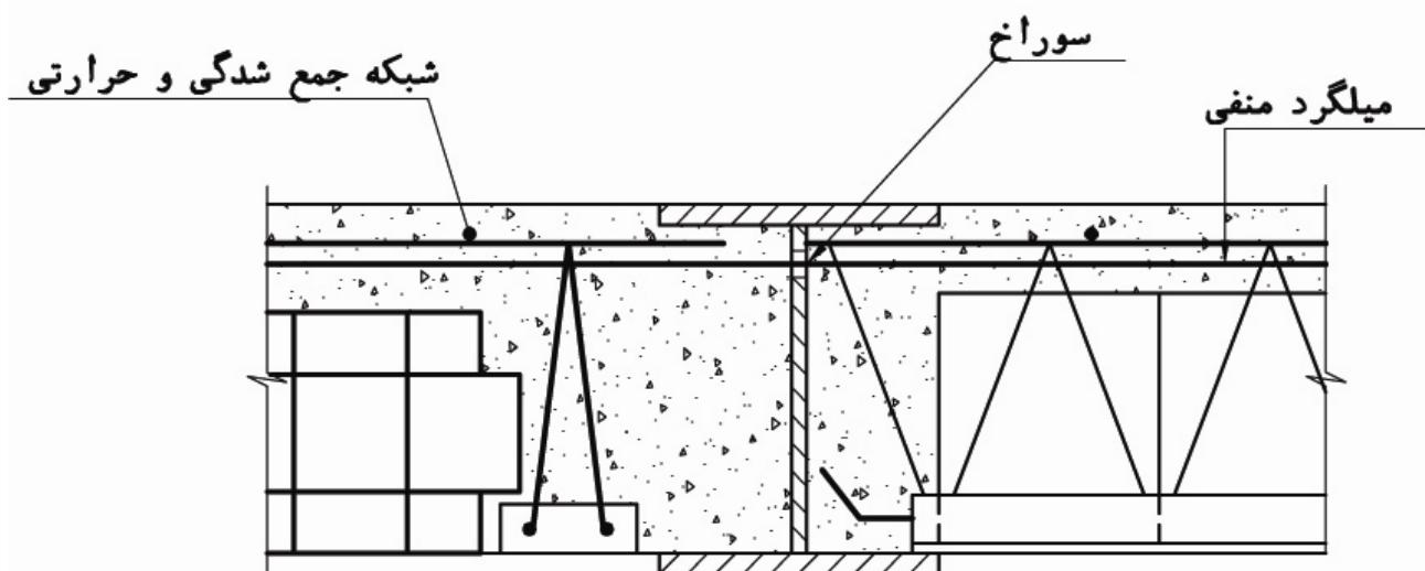
شکل ۱۴-۵- استقرار سقف تیرچه و بلوک روی تیر باربر فولادی، در حالتی که امتداد تیرچه‌ها، در یک طرف موازی امتداد تیر باربر و در طرف دیگر عمود بر آن باشد.
