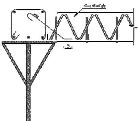
شکل ۱۱-۲ جزئیات اجرایی تیرچه‌ی فولادی با تکیه‌گاه مصالح بنایی یا بتنی
