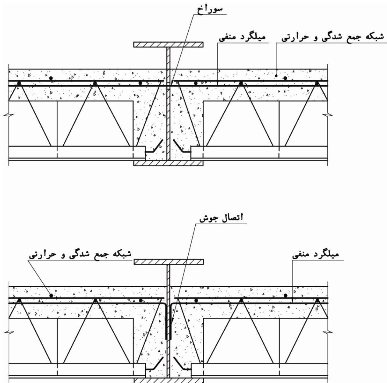
شکل ۱۲-۵- استقرار سقف تیرچه و بلوک روی تیرآهن، با ارتفاع بیشتر از ضخامت سقف تیرچه بلوک
