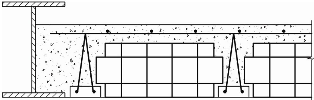
شکل ۱۷-۵- اتصال سقف تیرچه و بلوک به تیرآهن غیرباربر، با ارتفاع بیشتر از ضخامت سقف، شروع نصب تیرچه‌ها از کنار تیر غیر برابر
