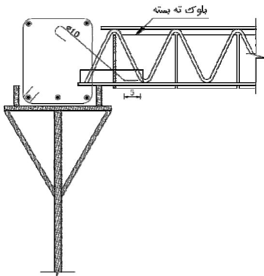
شکل ۱۲-۳ - نحوه‌ی کارگذاری قالب چوبی در محل اتصال تیرچه به تیر فولادی (حالت دوم)
