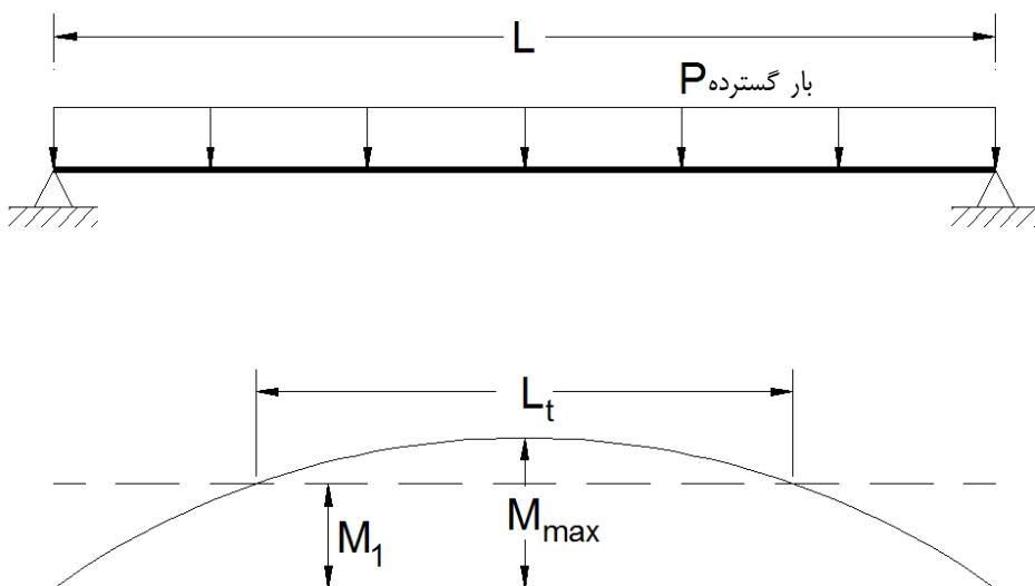
شکل پ ۳-۹- نمودار لنگر خمشی تیر دو سر ساده با بار گستردہ
