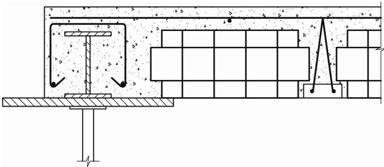
شکل ۲۱-۵- اتصال سقف به تیرآهن غیرباربر، با ارتفاع کمتر از ضخامت سقف، در تکیه‌گاه کناری
