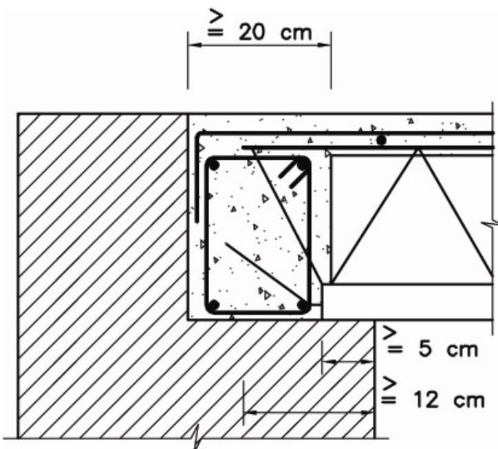
شکل ۵-۵- استقرار سقف تیرچه و بلوک روی دیوار در حالت کفايت طول پاشنه تیرچه
