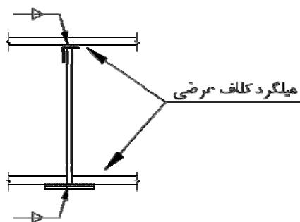
شکل ۱۶-۳ - اجرای کلاف عرضی به وسیله قالب بندی
