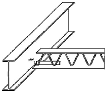
شکل ۱۳-۲- جزئیات اتصال تیرچه به تکیه گاه فولادی
