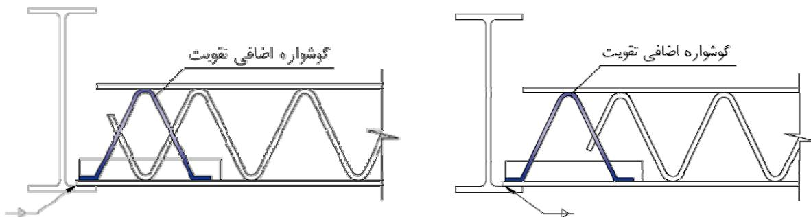
شکل ۸-۳- نحوه اتصال تیرچه به تیر فولادی با تقویت گوشواره
