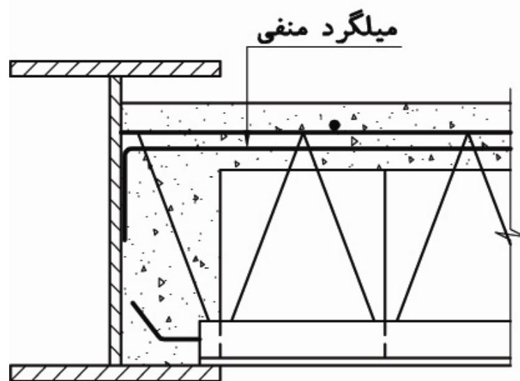
شکل ۱۶-۵ - استقرار سقف تیرچه و بلوک روی تیر باربر فولادی با ارتفاع بیشتر از ضخامت سقف، در تکیه‌گاه کناری
