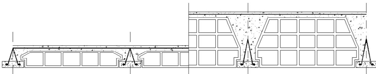
الف- عدم احتساب آرماتور بالایی به عنوان آرماتور افت و حرارت
