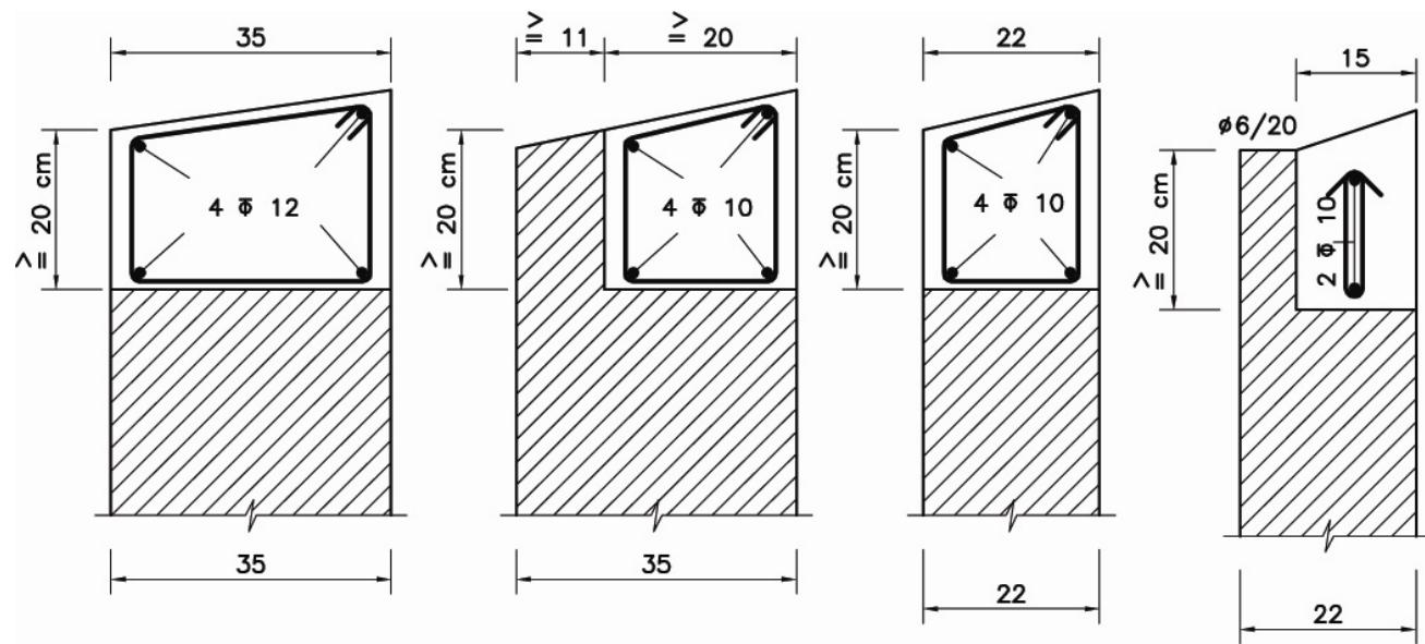
شکل ۹-۵- جزییات کلاف در اسقرار سقف شیبدار، روی دیوار باربر
