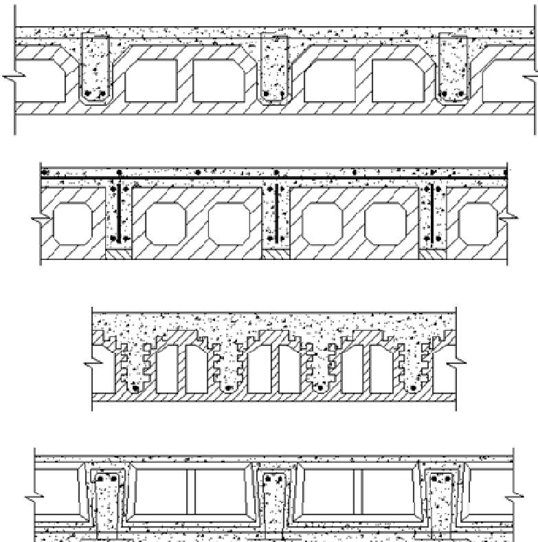
شکل ۱-۴- بکارگیری بلوک‌ها در دال با پشت بند
