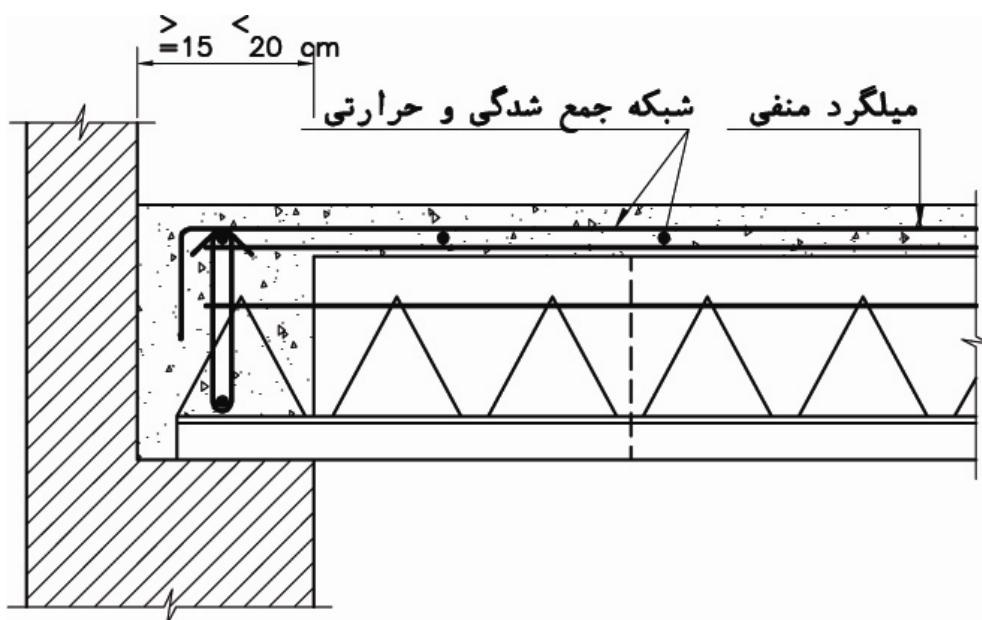
شکل ۳-۵- استقرار سقف به کمک کلاف کم عرض شامل حلقة دوخت
