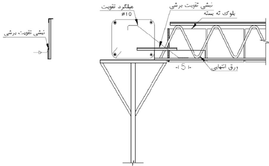
شکل ۱۳-۳- نحوه‌ی تعییه‌ی نبشی در محل اتصال (تقویت برشی)
