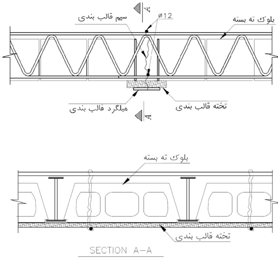
شکل ۱۷-۳- جزئیات اجرای کلاف عرضی به وسیلهٔ قالب‌بندی
