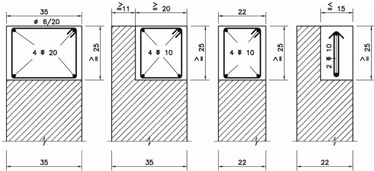
شکل ۸-۵- جزییات کلاف در استقرار سقف بدون شیب، روی دیوار باربر
