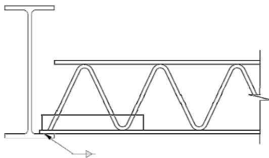
شکل ۷-۳- نحوه اتصال تیرچه به تیر فولادی بدون نیاز به تقویت
