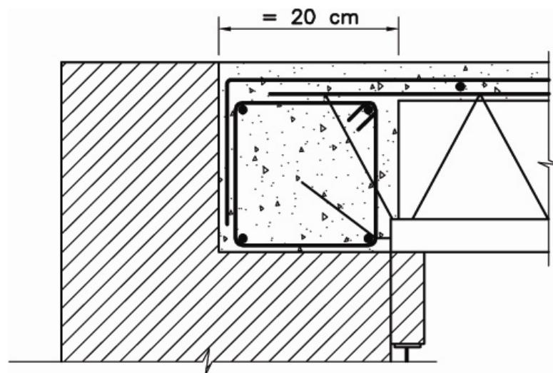
شکل ۵-۴- استقرار سقف تیرچه و بلوک روی دیوار در حالت عدم کفايت طول پاشنه تیرچه
