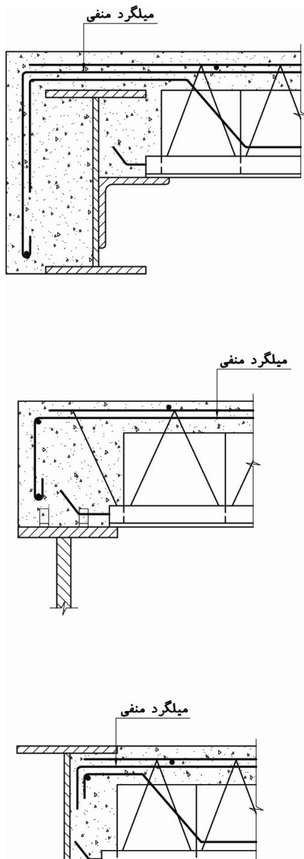
شکل ۱۵-۵- استقرار سقف تیرچه و بلوک روی تیر باربر فولادی با ارتفاع مساوی یا بزرگتر از ضخامت سقف در تکیه‌گاه کناری
