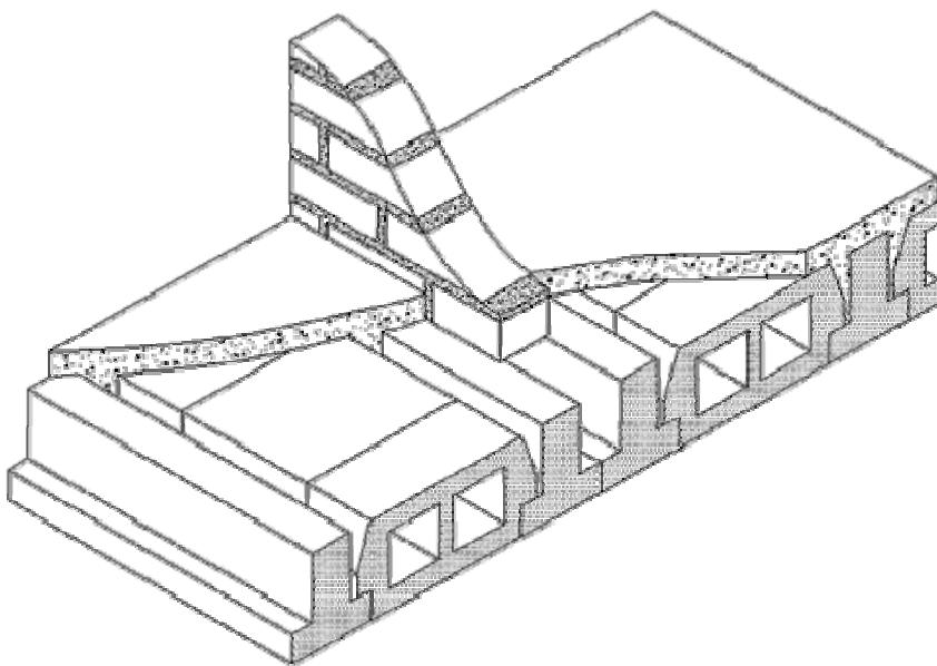
شکل ۲۱-۳- نحوه اجرای تیغه روی سقف تیرچه و بلوک
