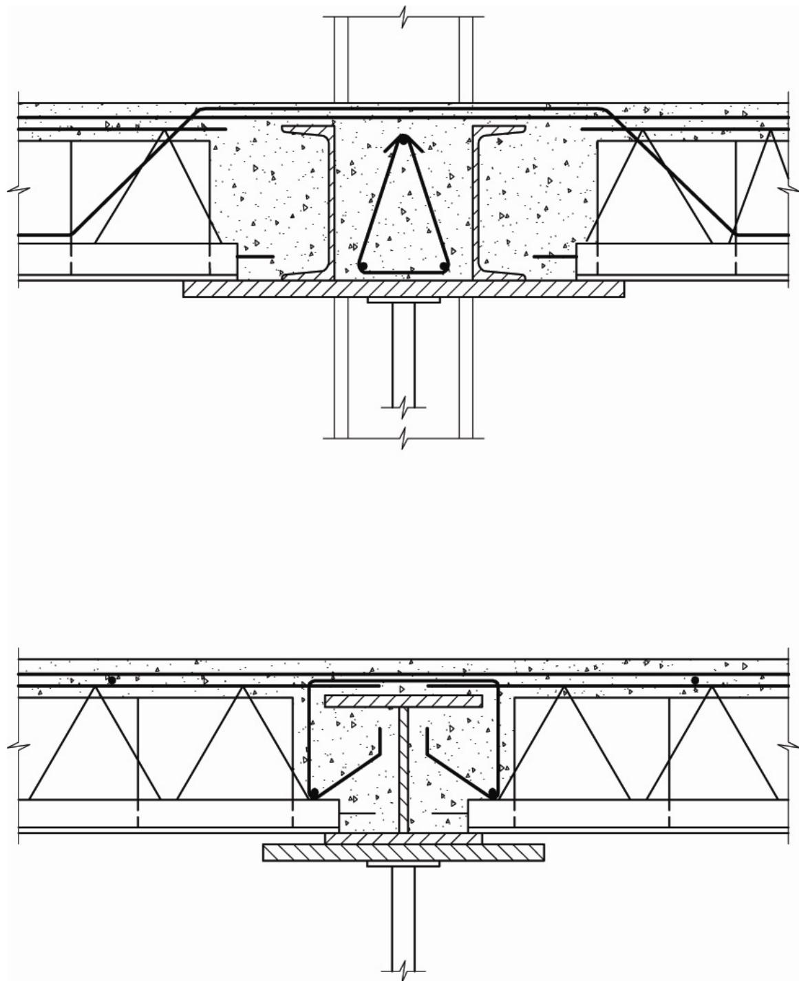
شکل ۱۰-۵ - استقرار سقف تیرچه و بلوك روی تیرآهن، با ارتفاع مساوی و يا ارتفاع کمتر از ضخامت سقف و نحوه قالب‌بندی
