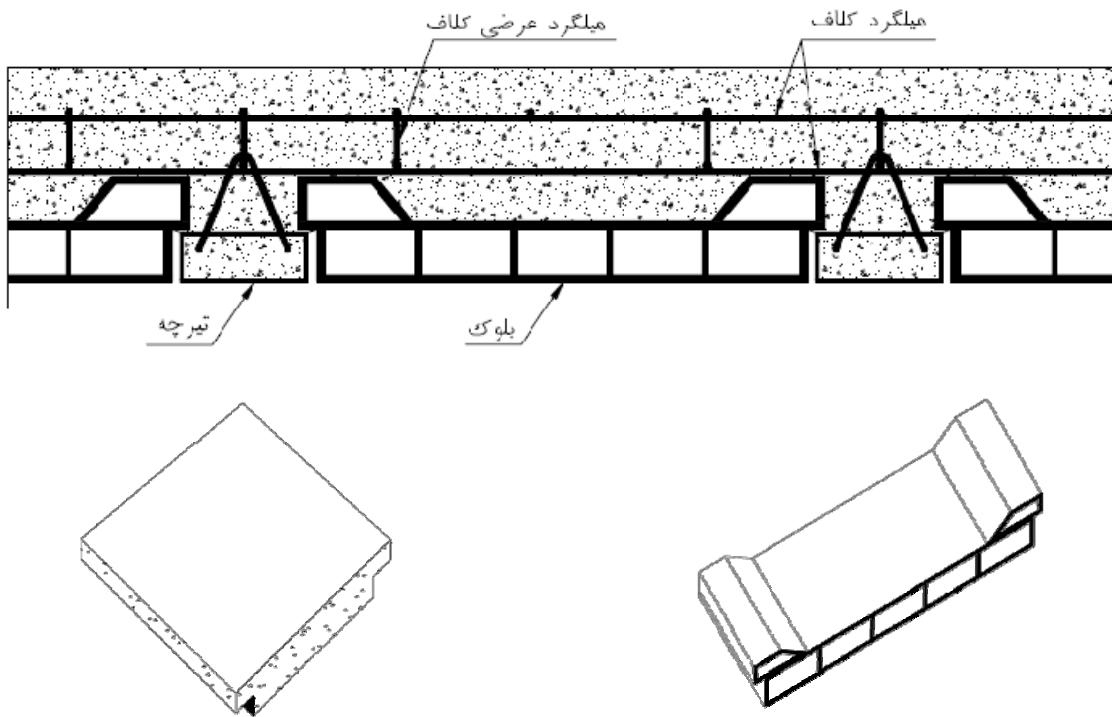
شکل ۴-۳- استفاده از بلوک‌های با ارتفاع کم برای حذف قالب‌بندی کلاف بتی
