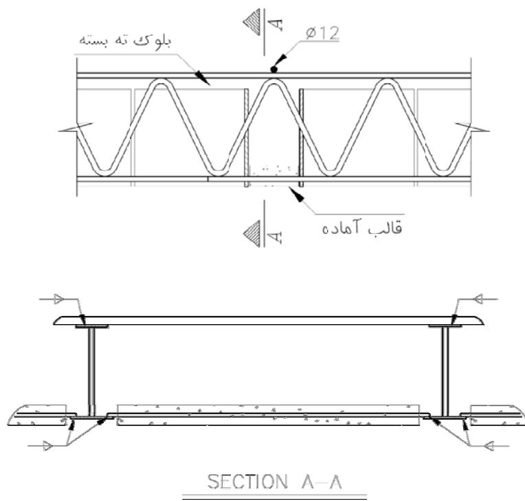
شکل ۱۵-۳ - نحوه اتصال میلگرد های کلاف عرضی به تیرچه هی فولادی
