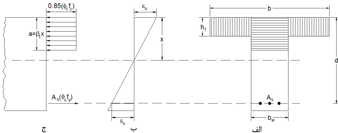
شکل پ ۶-۳- توزیع تغییر شکل نسبی (کرنش) و تنش در مقطع T شکل
